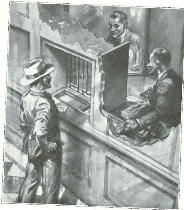
Un nouveau moyen de protection des caissiers. L'employé, situé en retrait du guichet, est vu par le visiteur réfléchi dans un miroir ; c'est donc son image seule qui semble converser avec le client. En outre, il glisse l'argent par un tiroir-guissière latérale de sécurité.
